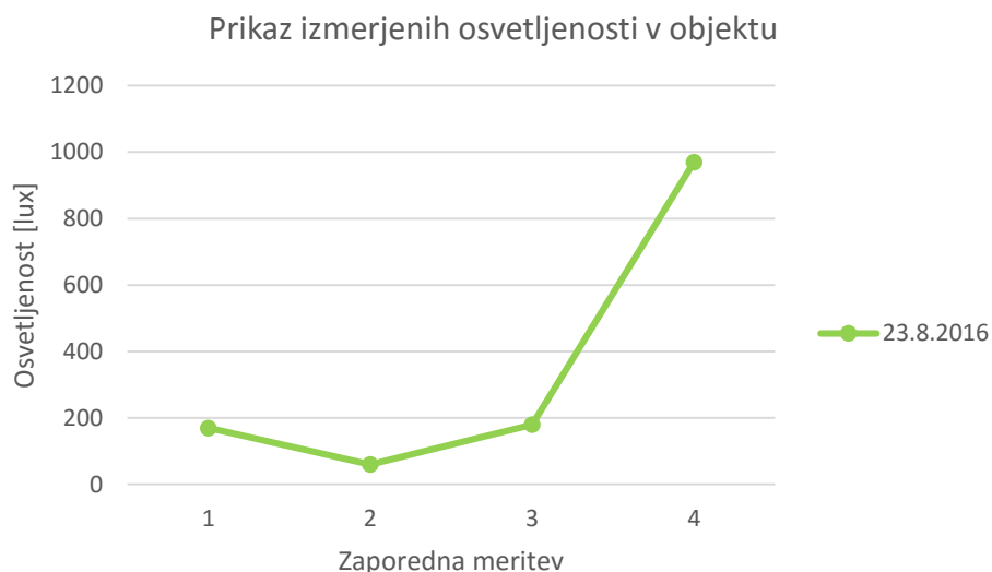
Slika 12: Izmerjene vrednosti osvetljenosti v notranjosti objekta.
